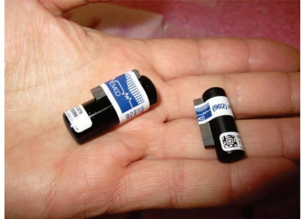
Die für die Aale verwendeten akustischen Sender haben eine zylindrische Form (36 x 13 mm). Zur Aktivierung der Sender wird der angeklebte Magnet entfernt.
